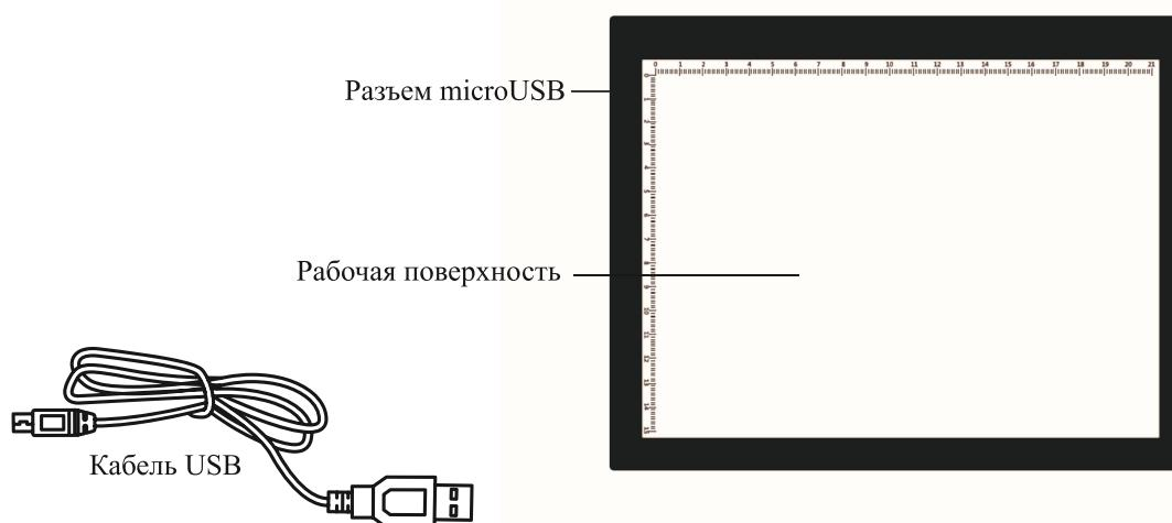
Светокопировальный (LED) планшет со встроенным аккумулятором
